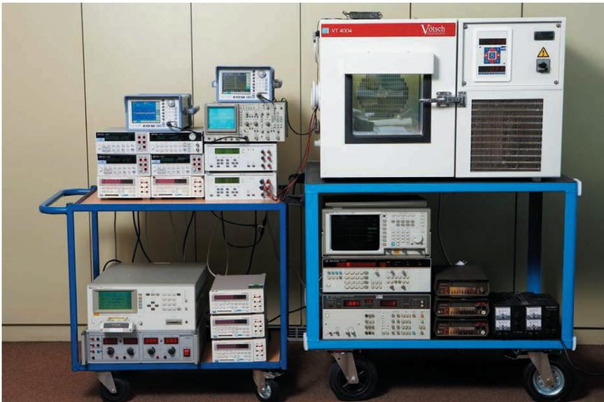
die Umsetzung steht ein Labor mit Thermostreamer und Temperaturkammer zur Verfügung, auch Hochfrequenzmessungen bis in den GHz-Bereich können durchgeführt werden. Ein eigener SMD-Bestückungsautomat dient zur Herstellung von Prototypen und Kleinserien. Typische Kunden sind produzierende Unternehmen mit hohem Mess- und Prüfaufwand in der Qualitätssicherung (Elektronik-, Automobilindustrie, Medizintechnik, ...)
