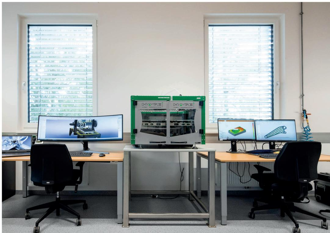
Abbildung 14: Hage 3Dp-A2 Großformat-Drucker (FFF-Verfahren für Kunststoff) im Rapid Prototyping Lab.
