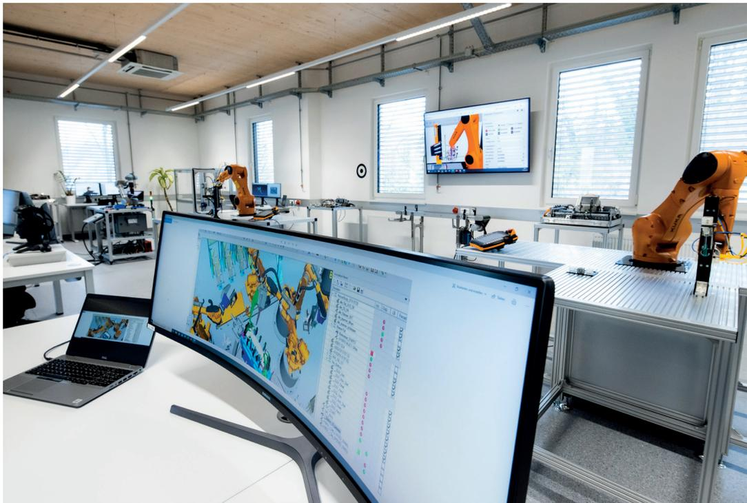
Abbildung 5: Kuka-Industrieroboter mit virtuellem Zwilling der Anlage im Mechanical Engineering and Robotics Lab.
