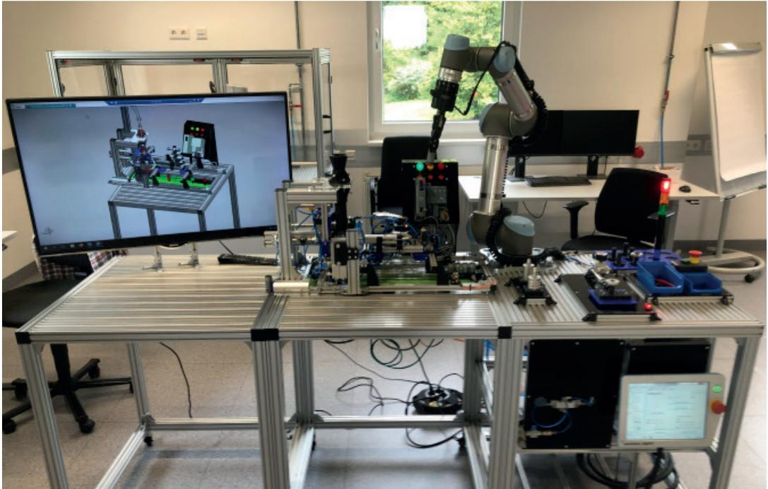
Abbildung 3: Digitaler Zwilling in der Prozessentwicklung zur Kopplung der virtuellen und der realen Abbildung einer Anlage im Mechanical Engineering and Robotics Lab.
