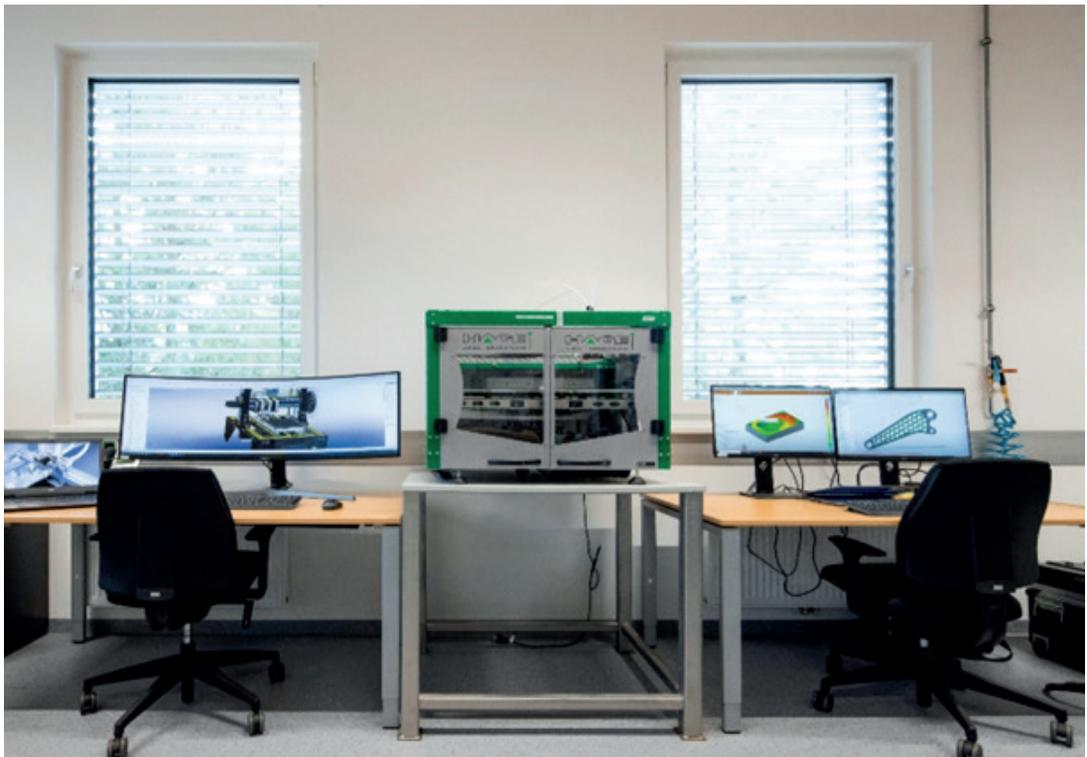
Abbildung 14: Hage 3Dp-A2 Großformat-Drucker (FDM-Verfahren für Kunststoff) im Rapid Prototyping Lab.
