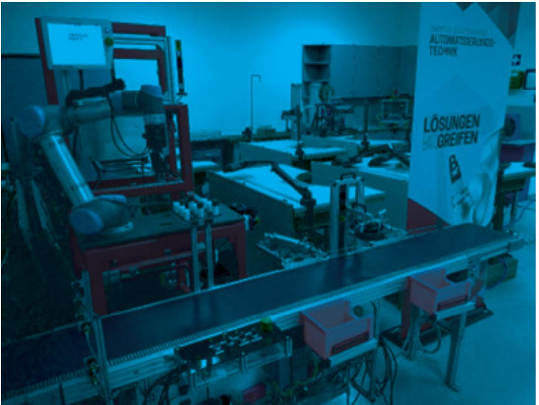
Abb. 13: Demoaufbau zum Thema MRK mit einem Universal Robot
