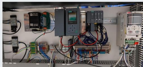
Abb. 4: Schaltschrank des Testaufbau
