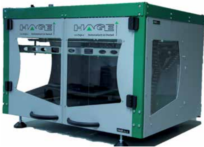
Abb. 8: Hage 3D Großformat-Drucker (FDM-Verfahren)
