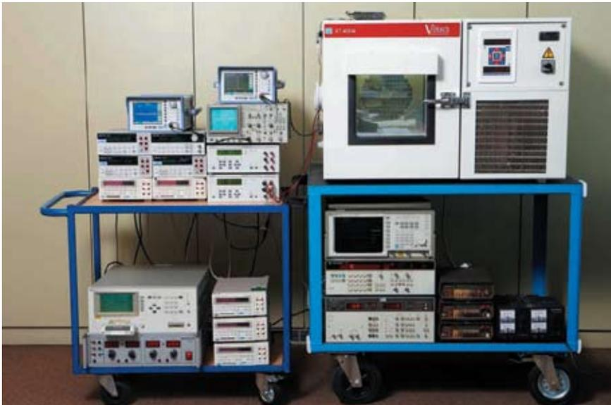
die Umsetzung steht ein Labor mit Thermostreamer und Temperaturkammer zur Verfügung, in dem auch Hochfrequenzmessungen bis in den GHz-Bereich durchgeführt werden können. Ein eigener SMD-Bestückungsautomat dient zur Herstellung von Prototypen und Kleinserien. Typische Kunden sind produzierende Unternehmen mit hohem Mess- und Prüfaufwand in der Qualitätssicherung (Elektronik-, Automobilindustrie, Medizintechnik, ...).
